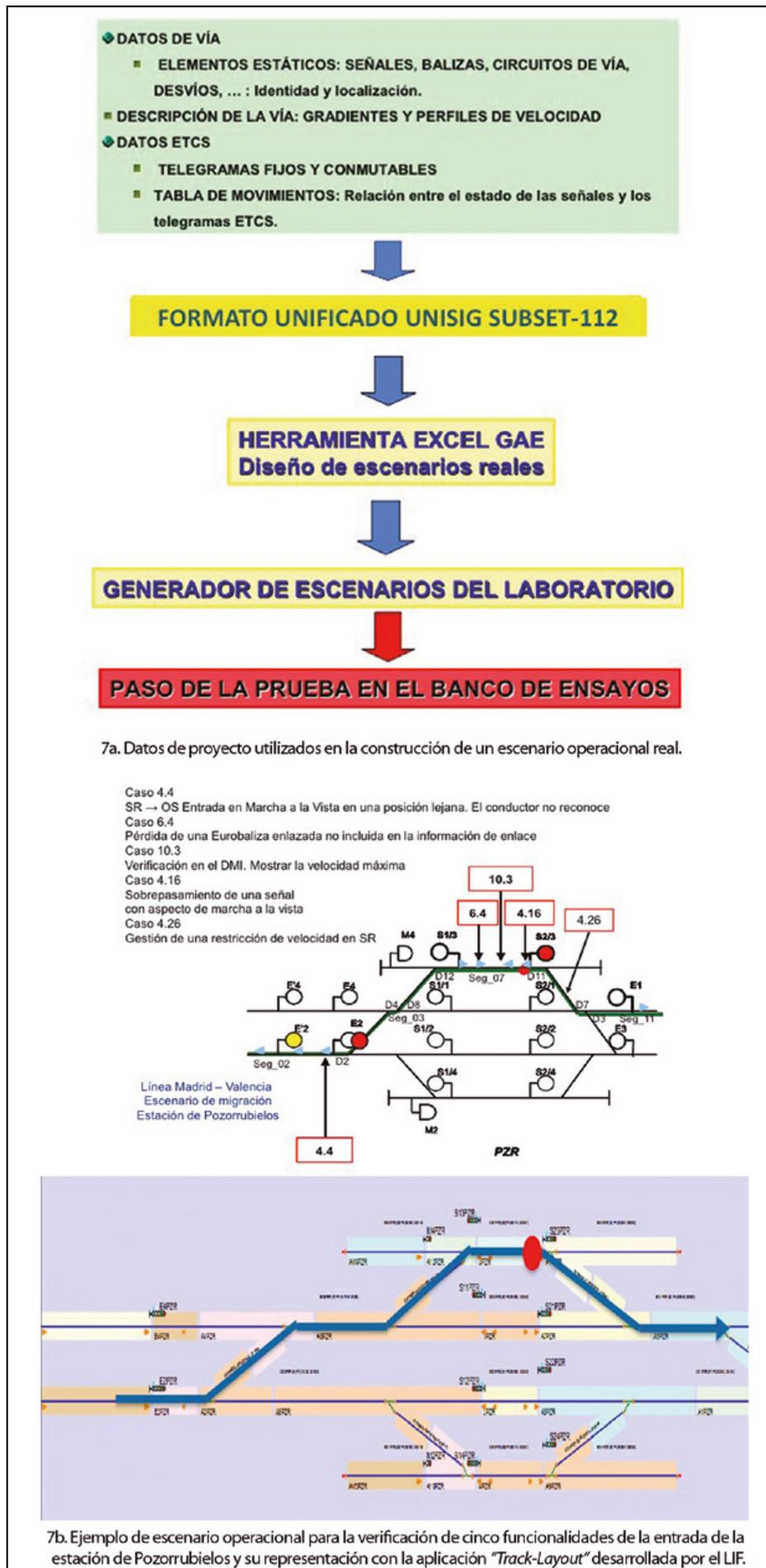
**Figura 7.** Construcción de un escenario operacional real con datos de proyecto y su representación gráfica con la aplicación LIF "Track-Layout".
