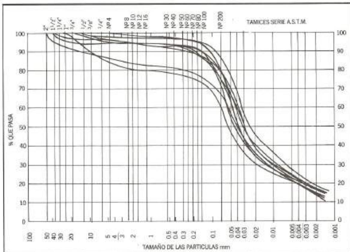
FIGURA 2. Granulometría de las muestras obtenidas en el relleno.
