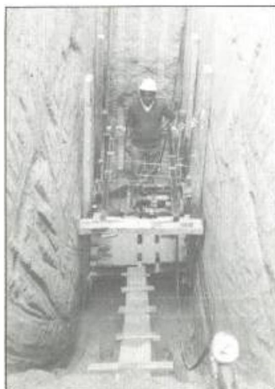
FIGURA 6. Ensayo de deformabilidad horizontal \phi 60 cm.
