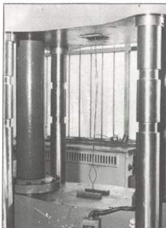
FOTO 1. Ensayo de tracción de torzal bifilar de pretensado.
