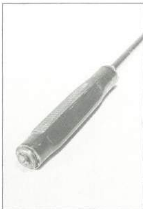
FOTO 4. Diseño de sistema de agarre para ensayo de fatiga de alambre de pretensado.
