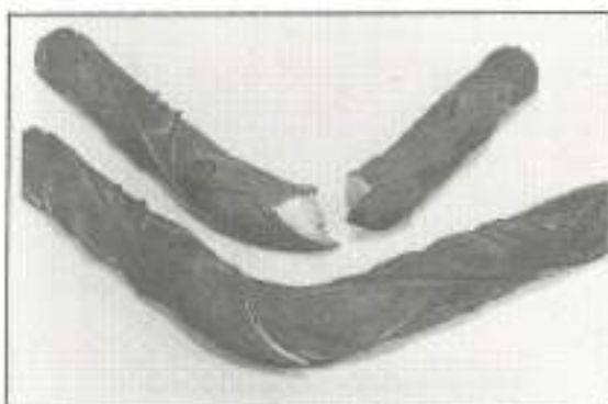
FOTO 6. Armaduras pasivas no aptas al doblado.
