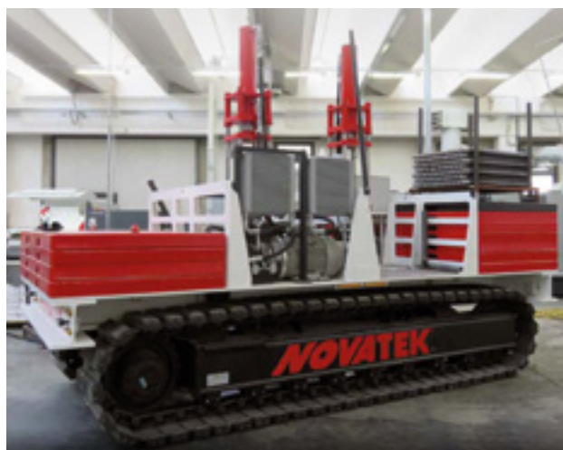
Figura 18. Máquina sobre orugas Track Pile. Cortesía de Geonovatek, 2017.
