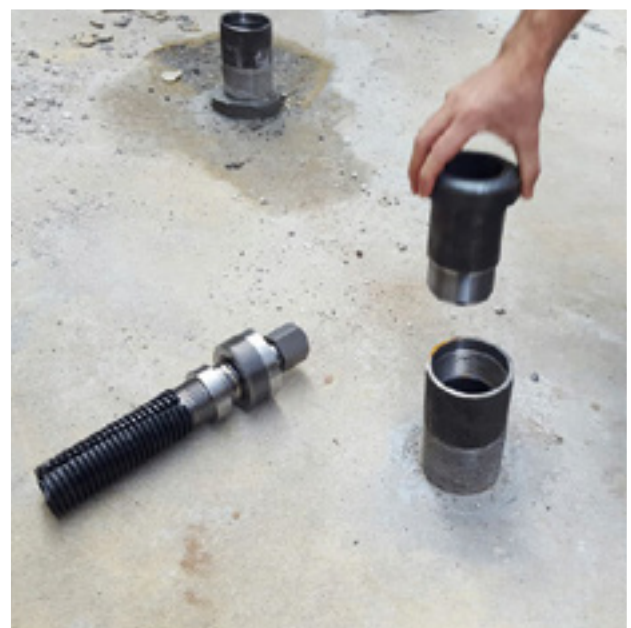
Figura 16. Casquillos usados para anclaje del sistema de hinca. Cortesía de Geonovatek, 2017.
