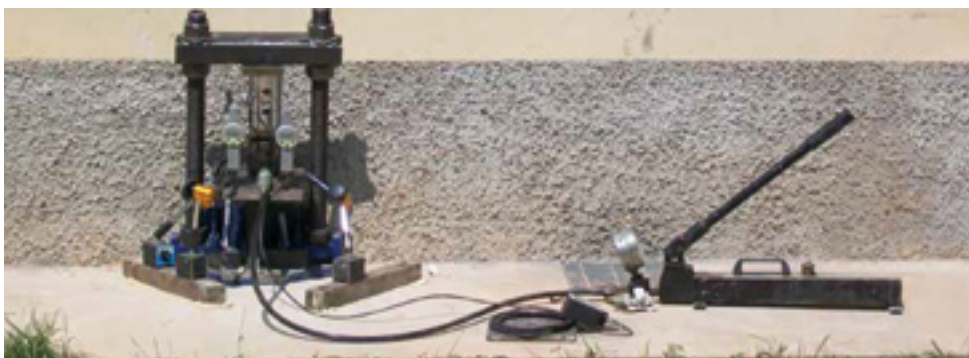
Figura 9. Ensayo de prueba de carga. Geonovatek, 2016.
