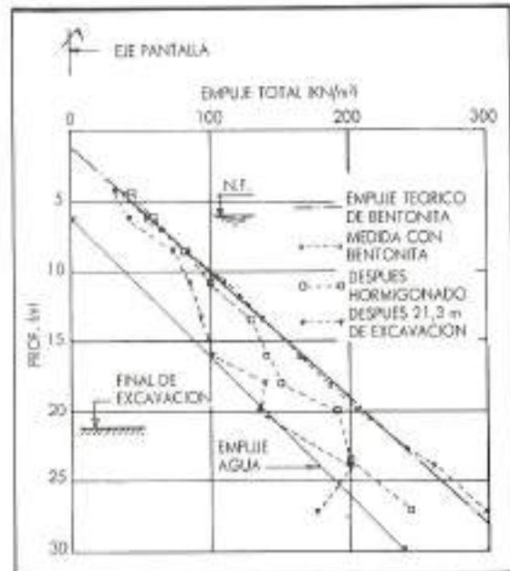
FIGURA 12. Empujes medidos en IS-4 durante las operaciones constructivas.
