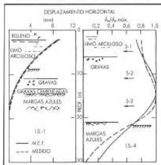
FIGURA 16. Comparación entre los desplazamientos horizontales de la pantalla calculados y medidos.
