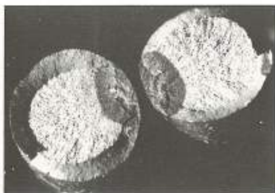
FOTO 16. Fisura de corrosión bajo tensión.
