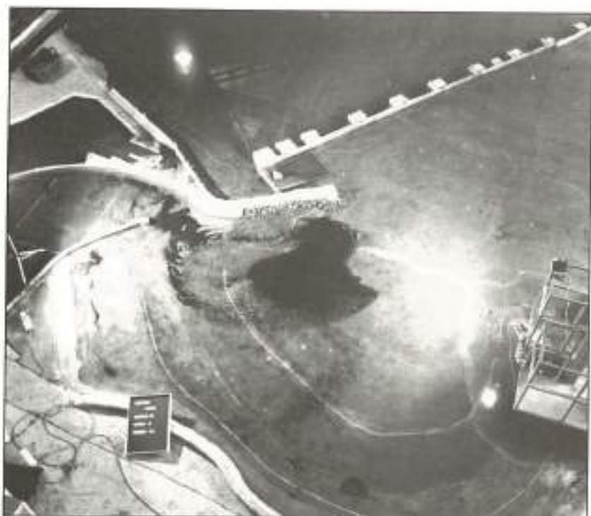
FOTOGRAFIA 4. Ensayos de Ondarra. Material móvil: carbón. Dique ampliado.
