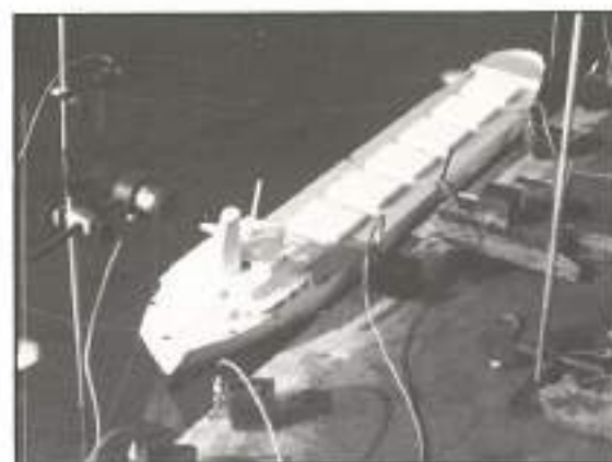
FIGURA 10. Disposición de un modelo de barco en un ensayo.
