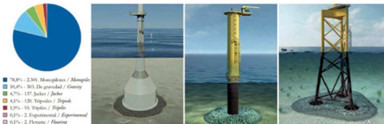
**Figura 1.** Cuota de utilización y representación de las distintas tipologías de cimentación a finales de 2014 (Fuente: EWEA).
