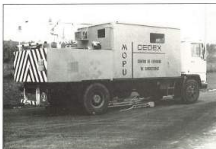
FOTO 1. Deflectógrafo. Vista general.
