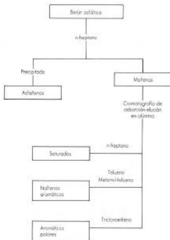
FIGURA 1. Esquema del método de separación de los componentes de un betún asfáltico.
