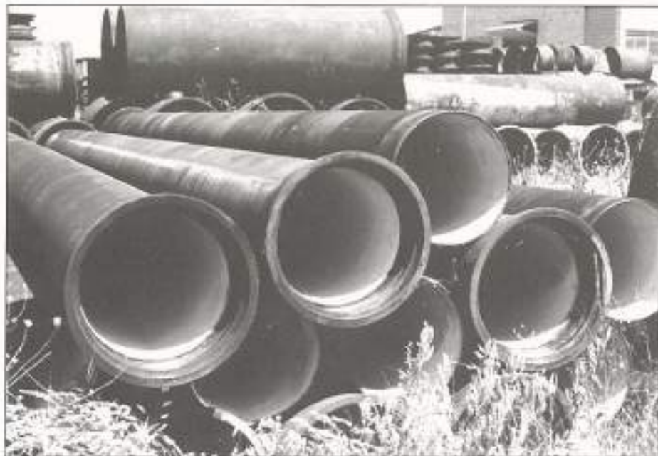
Tubos de fundición dúctil empleados en el abastecimiento y distribución de aguas, protegidos exteriormente con un producto bituminoso e interiormente con lechada de cemento, del tipo recepcionado en el laboratorio.
