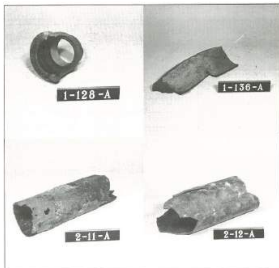
Muestras de tuberías rotas en servicio en su recepción en el laboratorio.
