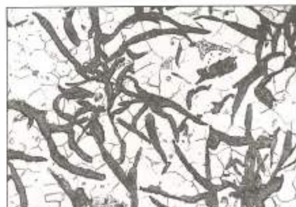
Estructura básica de una de las fundiciones centrífugas con las láminas de grafito sobre un fondo de perlita y núcleos de estanho. Aumentos \times 500 .
