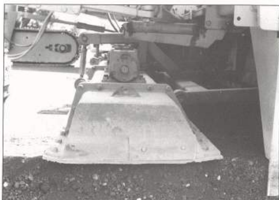
FOTO 12. Detalle del sistema de precompactación.
