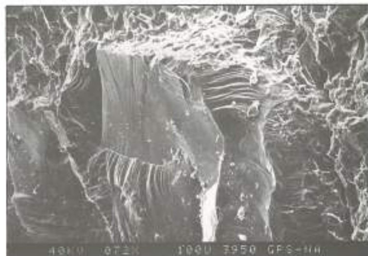
FOTO 4. Figuras de disolución en un cristal de cuarzo provocadas por la acción de los álcalis de la fase intersticial.
