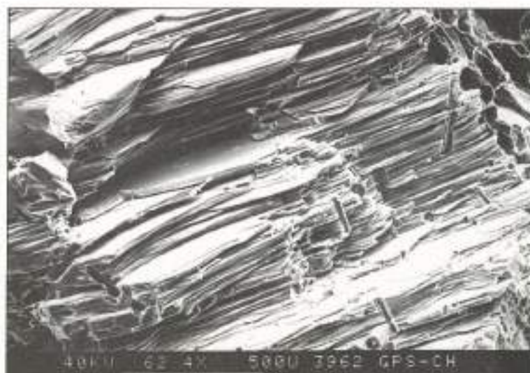
FOTO 3. Apertura y degradación de las láminas de una mica como consecuencia de una reacción árido-pasta de cemento.
