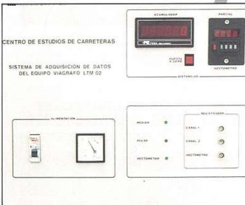
Equipo automático de captación y tratamiento de datos para deflectógrafo.
