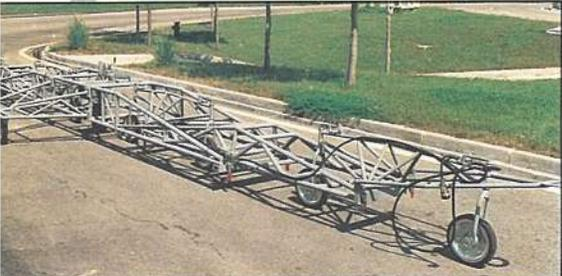
Equipo viágrafo: viga soporte y equipo de adquisición y edición de datos.
