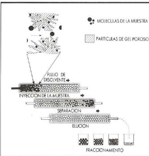
FIGURA 19. Esquema del mecanismo de separación por tamaños moleculares (Ref. Waters).
