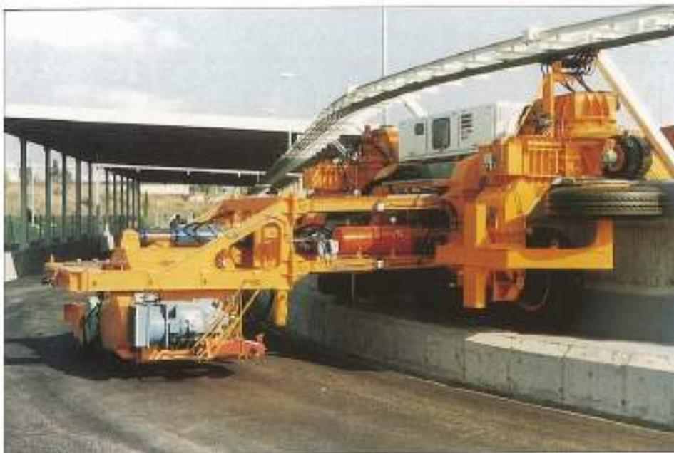
**FOTO 2.** Vista general del vehículo simulador de tráfico.
