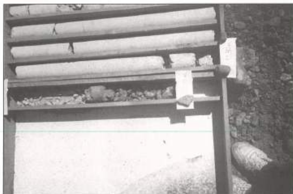
FIGURA 17. Caja de testigos correspondiente a la zona de punta del pilote, Caso 4.
