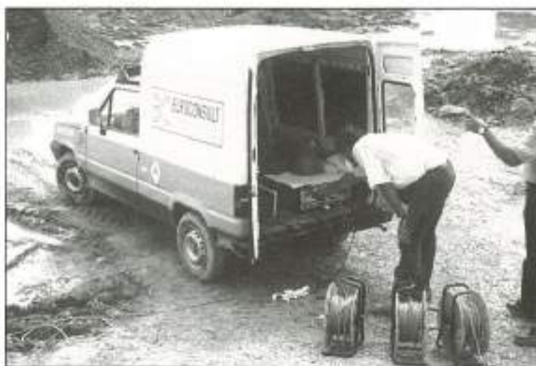
FIGURA 3. Registro de la señal en un ensayo por el método sísmico.
