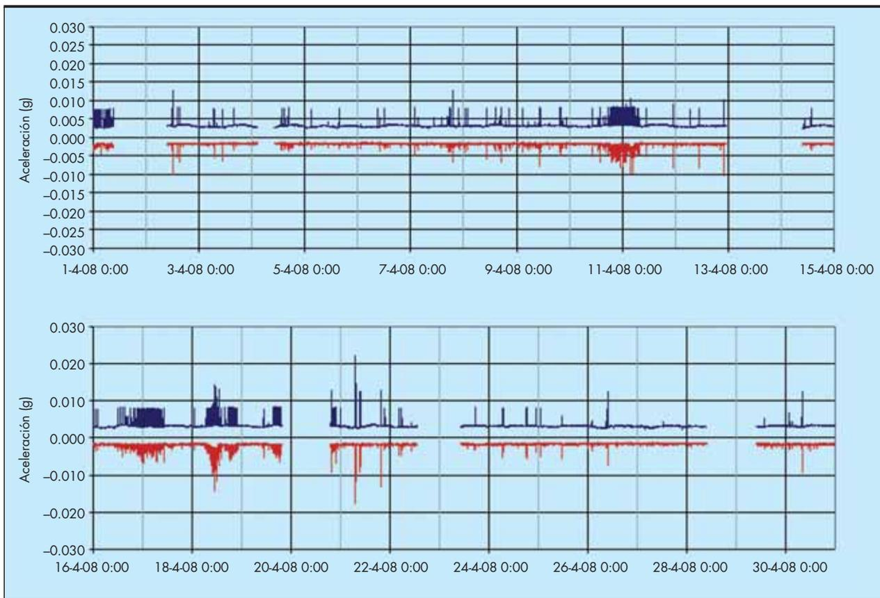
FIGURA 4. Máximos (azul) y mínimos (rojo) obtenidos de muestras de 90 segundos extraídas del parámetro "aceleración en X".
