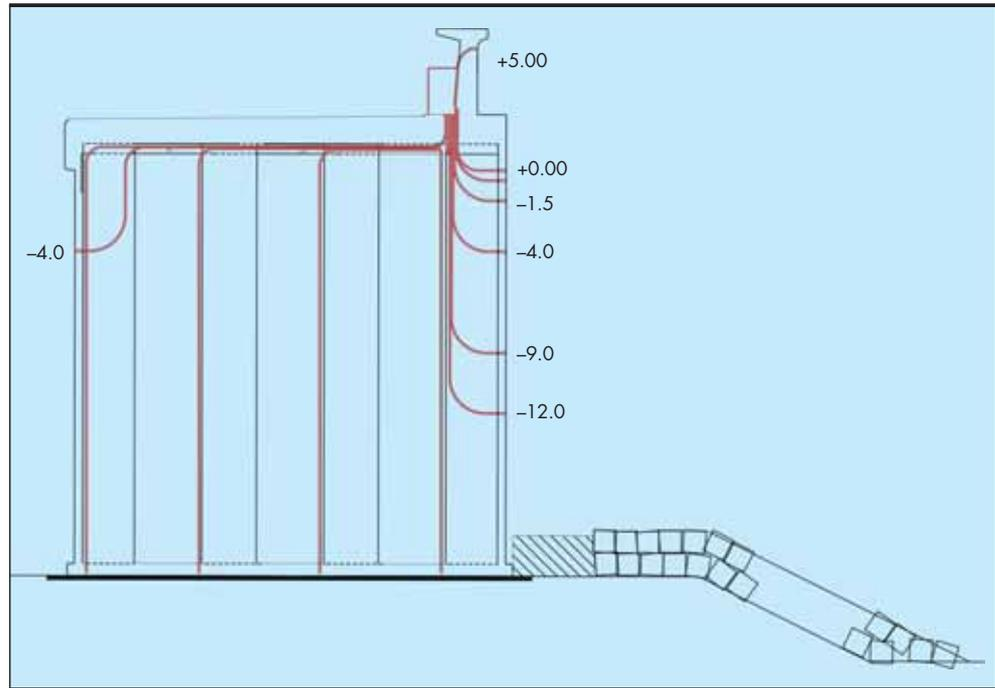
**FIGURA 2.** Sección instrumentada con doce sensores de presión y subpresión.
