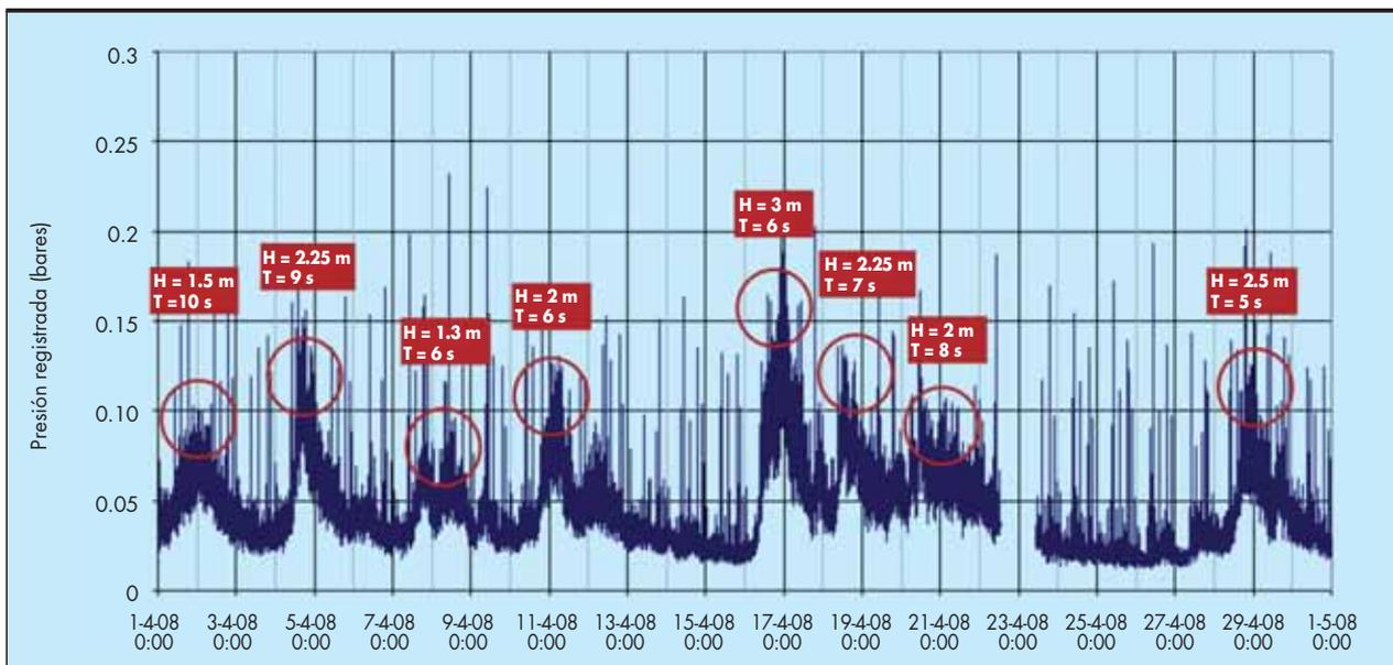
FIGURA 5. Valor (Máximo-Mínimo) obtenido de las estadísticas cada 90 segundos del registro del sensor 5 de la sección 2 del 1/4/08 al 1/5/08.
