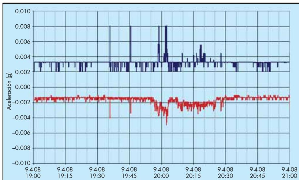
FIGURA 8. Máximos (azul) y mínimos (rojo) obtenidos de muestras de 5 segundos extraídas del parámetro “aceleración en X”.
