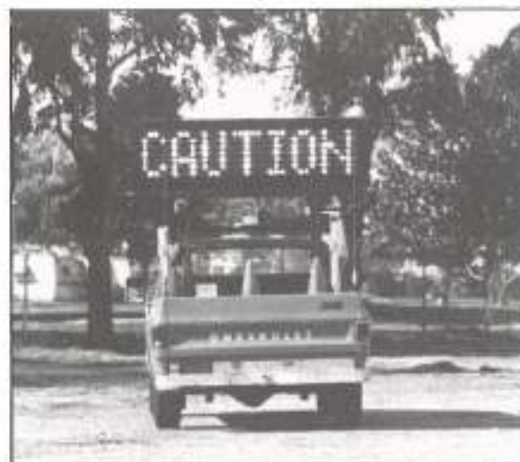
FOTO 16. Señal de matriz de lámparas de incandescencia.
