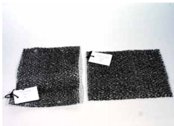
FIGURA 6. Geoestera del geodren.
