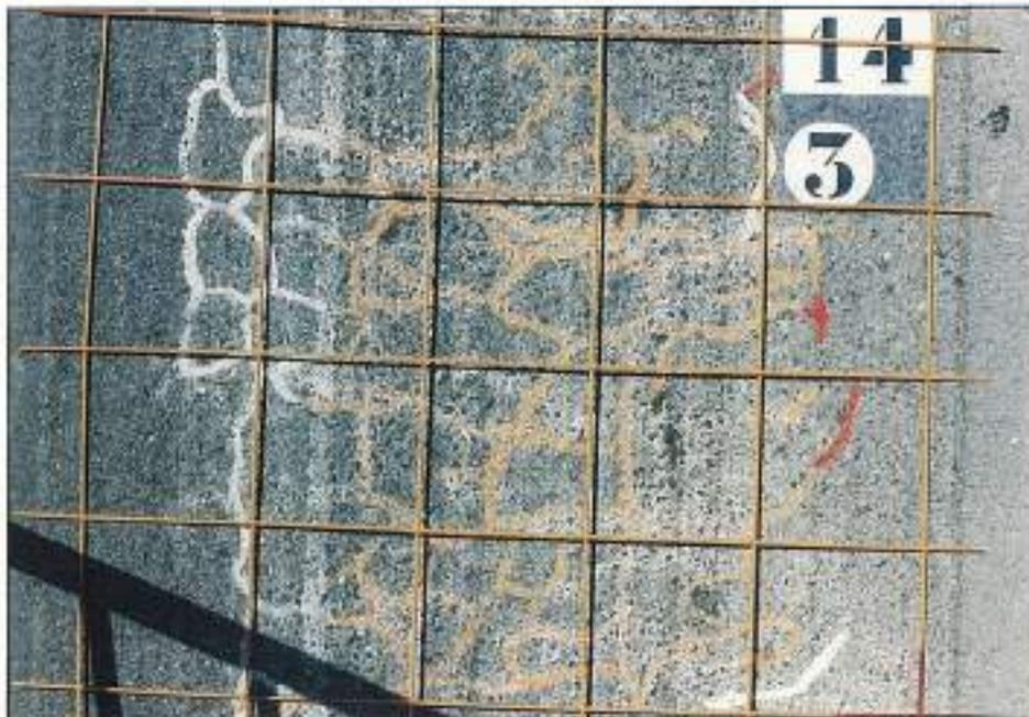
FOTO 1. Trama metálica sobre fisuras de la zona rodada. Sección 3, puntos 14 al 15.
