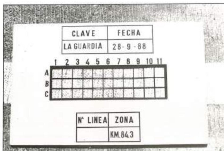
FIGURA 2. Grado de deterioro del material A a los seis meses de instalado en carretera.
