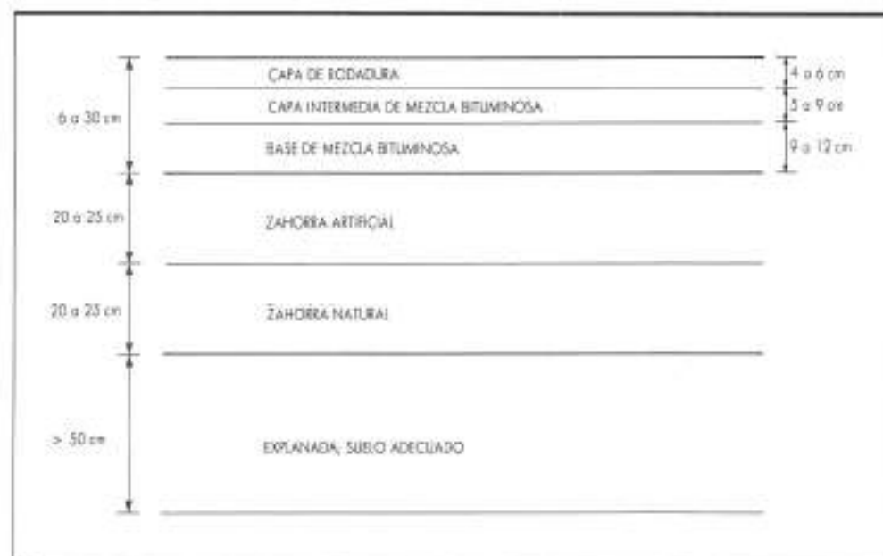
FIGURA 1. Composición de un firme flexible.
