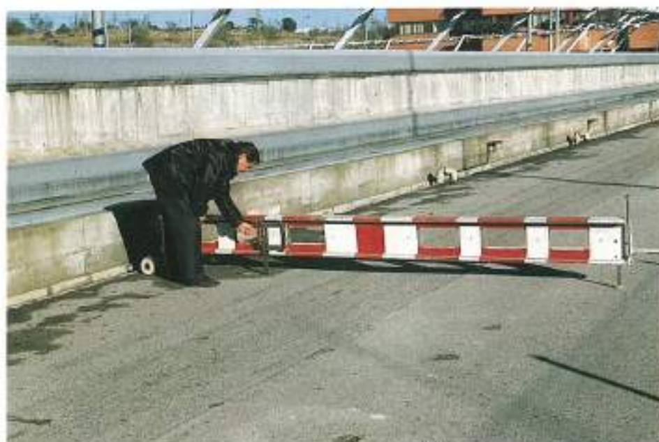
FOTO 1. Vista del transversoperfílogo en la pista de ensayo.
