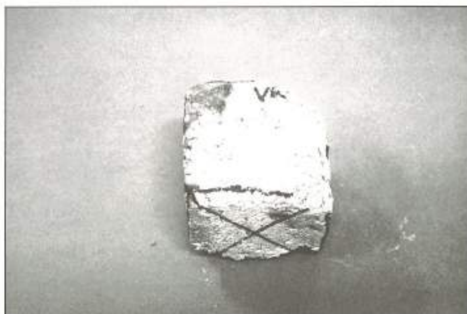
FOTO 6. Probeta de la muestra VR2 sometida al ensayo de heladicidad. En ella se pueden observar morfologías de alteración similares a las observadas en los sillares de los monumentos: descementación, desagregación granular, desplazación, etc., e incluso desmoronamiento.
