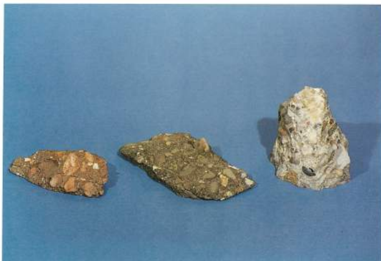
FIGURA 1. Diferencia de color: portland (derecha), aluminoso sin convertir (centro), aluminoso convertido (izquierda).
