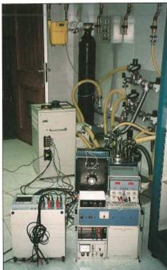
FIGURA 9. Banco de ensayos del almacenador superconductor.
