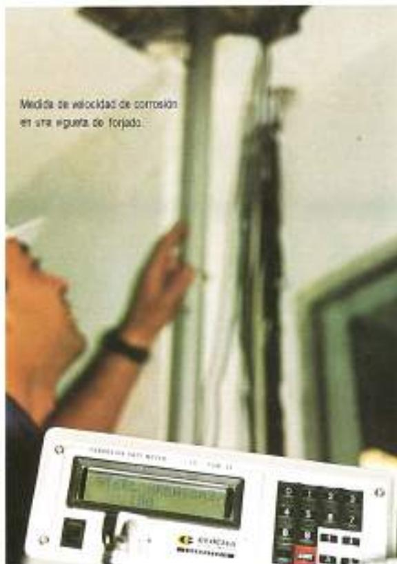
Medida de velocidad de corrosión en una vigueta de forjado.
