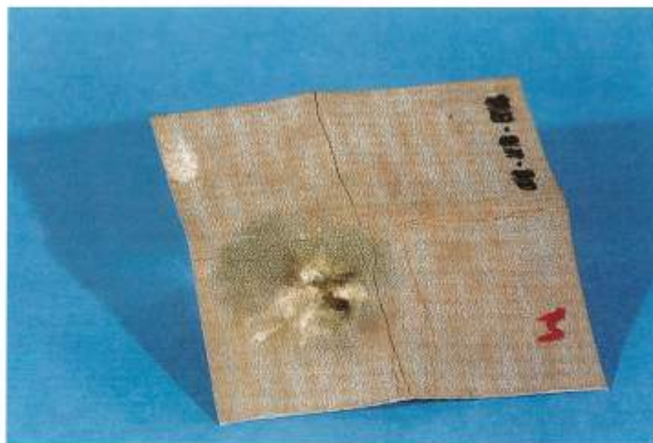
FIGURA 9. Probeta con agrietamientos en el lugar de la flexión, tras la prueba de doblado a bajas temperaturas. (Balsa F).
