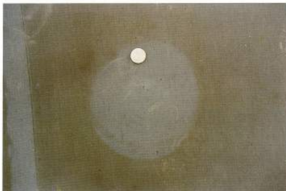
FIGURA 19. Zona degradada, con cambio de color y perforación. (Balsa F).
