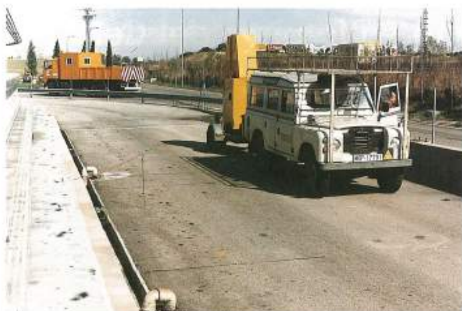
FOTO 1. Utilización del defleómetro de impacto en la pista de ensayo.
