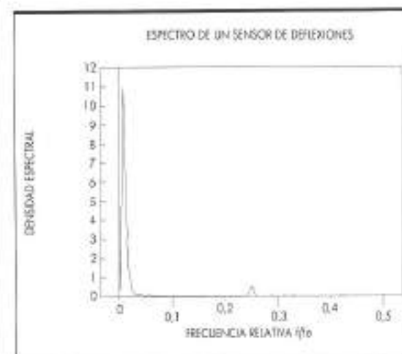
FIGURA 2. Densidad espectral de un sensor de deflexiones. Esta gráfica muestra la presencia de una forma de ruido: una componente de 50 Hz de la red. Esta componente era una constante en la toma de datos y sería filtrada. Frecuencia de muestreo f_0 = 200 Hz.
