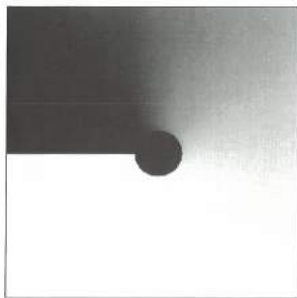
FOTO 3. Imagen de la LUT bidimensional. En este caso se descartan pixels con valor de umbral inferior a 20 pixels.
