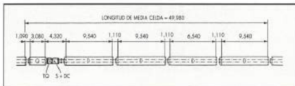
FIGURA 1. Media celda de imanes en el LHC.
