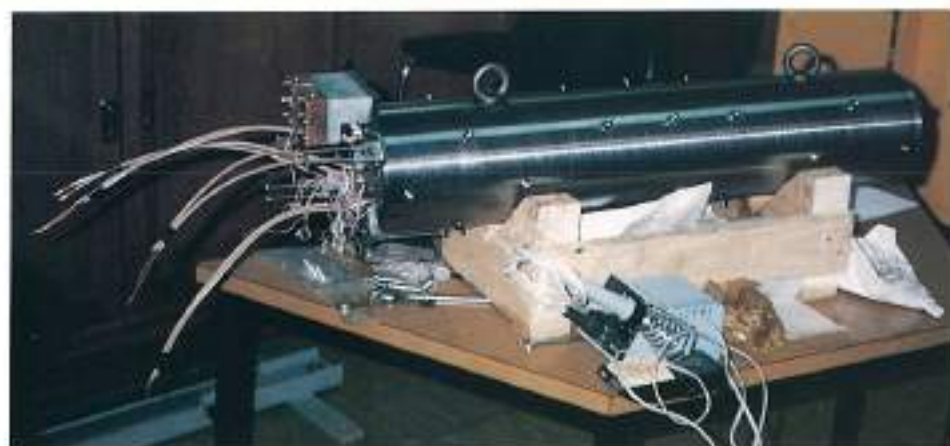
FIGURA 8. Fase final en la fabricación del imán. (Foto INDAR).
