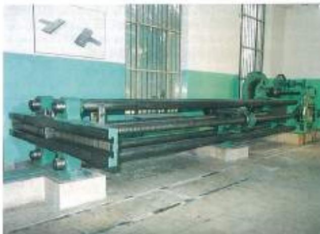
FOTO 2. Prensa horizontal universal estática Amsler de  $300 \text{ T}$ .
