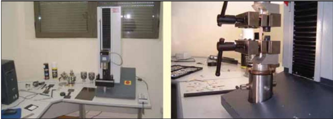
FIGURA 3. Máquina universal de ensayos MTS Synergy de sobremesa.
