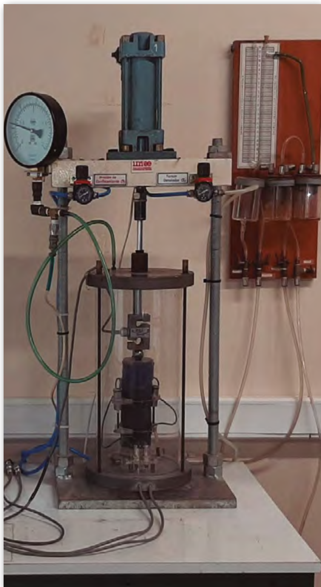
Figura 4. Ensayo triaxial dinámico para medida del módulo resistente en suelos y materiales granulares (Laboratorio IMAE, Rosario, Argentina) [1].
