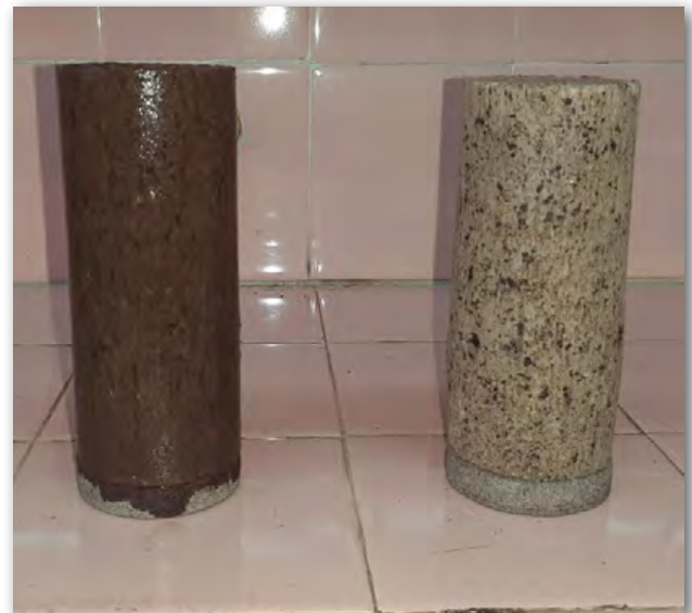
Figura 10. Probetas de SAE antes (izq.) y después del curado (dcha.) impuesto por el TG-2 [13].
