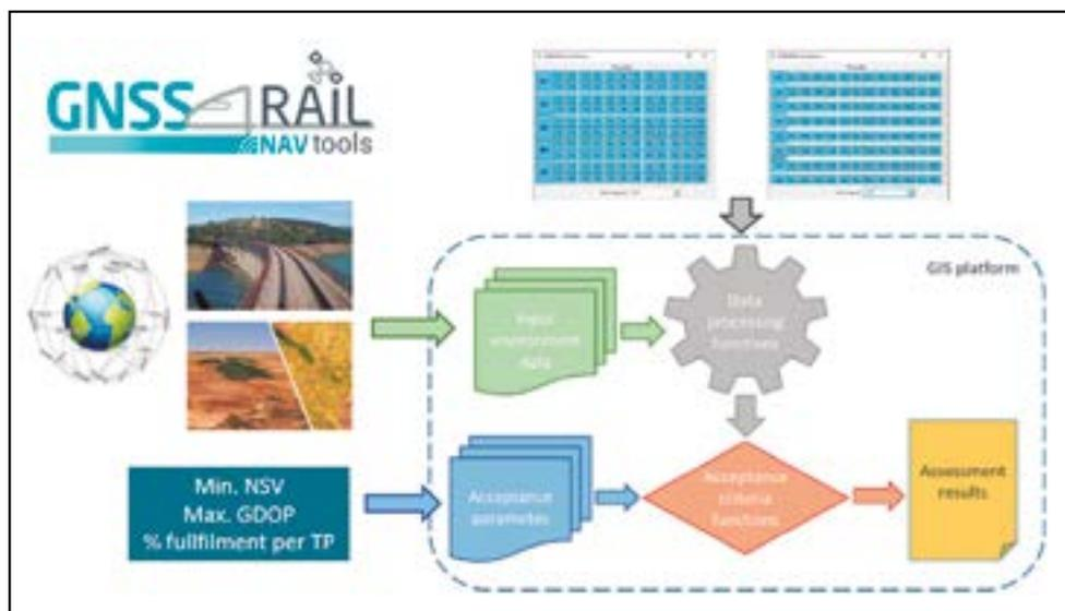
Figura 4. Parámetros y esquema básico de la herramienta GNSS4RAIL.
