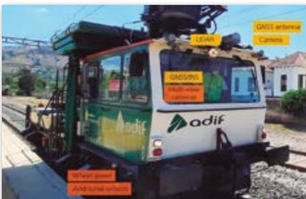
Figura 29. Tipos de dispositivos que se instalarán en el vehículo de pruebas.
