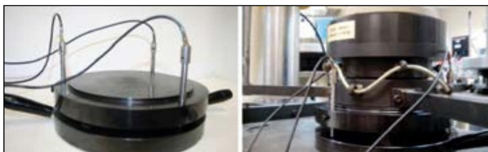
**Figura 40.** Ensayo para caracterizar los materiales elásticos. Detalle de los LVDTs (izda) y equipo durante el ensayo (dcha).
