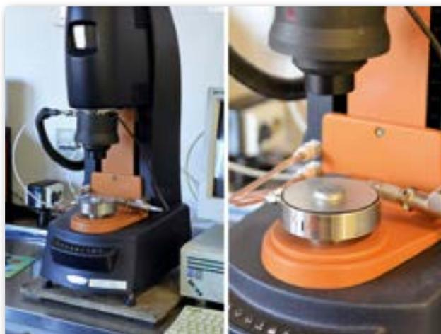
**Figura 1.** Reómetro DSR.
