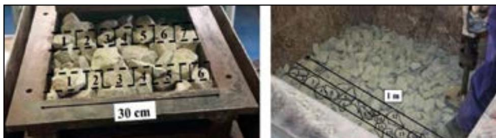
**Figura 39.** Balasto andesítico colocado en la caja de corte de 30 x 30 cm (izda) y en la caja de corte de grandes dimensiones (dcha).
