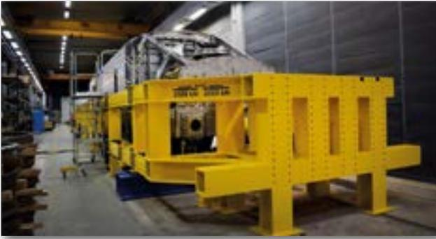
**Figura 16.** Banco de ensayo de cajas.
