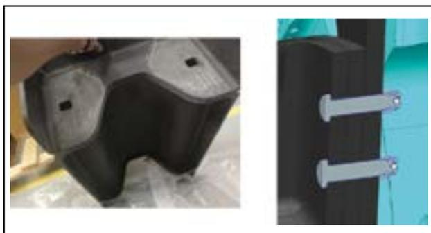
Figura 6. Zona mecanizada y diseño de una unión con perno remachable.
