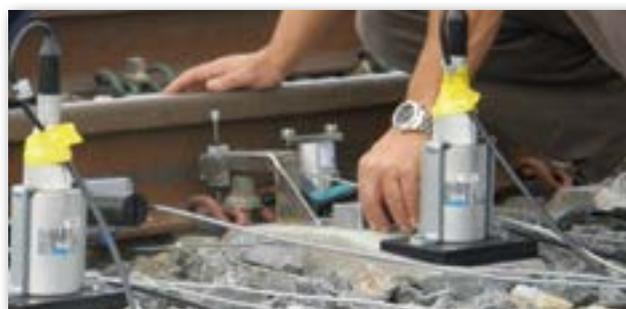
**Figura 29.** Potenciómetro y geófonos.
