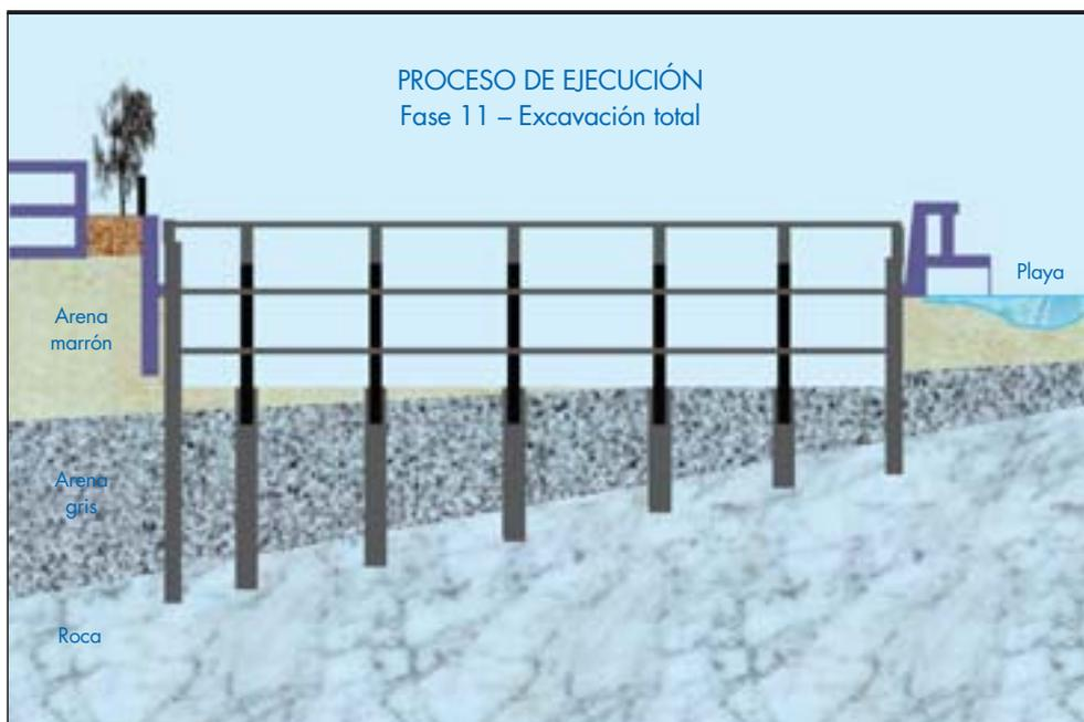
**FIGURA 8.** Fase final de excavación (Sección transversal al Paseo de la Concha).
