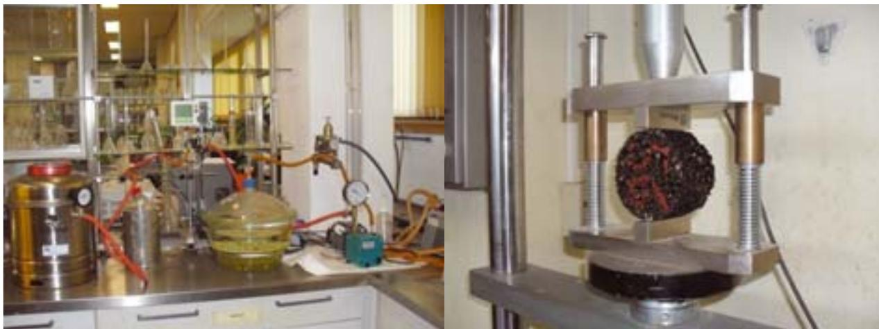
FIGURA 1. Dispositivos de saturación y rotura de las probetas.
