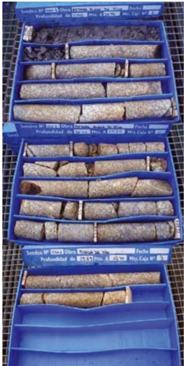
FIGURA 8. Cajas de testigos del primer sondeo.
