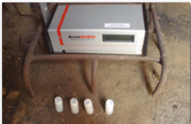
Figura 8. Disposición de los cuatro viales con el centelleo sólido de ZnS(Ag) (detectores) y monitor continuo de radón AlphaGUARD PQ 2000PRO en un almacén en la Sierra de Gredos.
