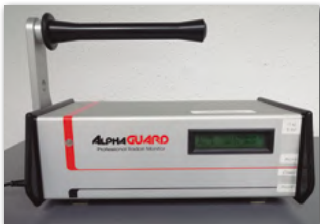
Figura 7. Equipo AlphaGUARD PQ 2000PRO para medidas en continuo de ^{222}\text{Rn} . Este equipo se ha utilizado para la calibración del método propuesto.
