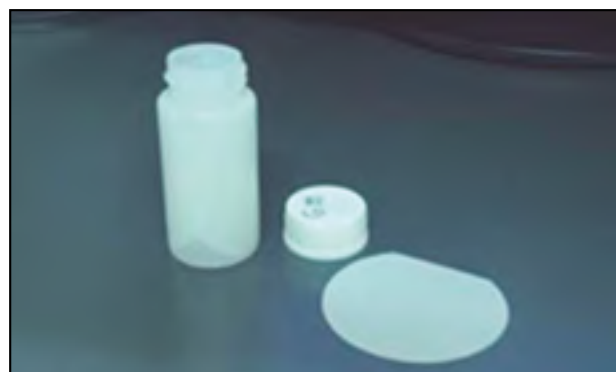
Figura 5. Vial de polietileno teflonado con dos láminas de \text{ZnS(Ag)} en su interior. Se observa en el exterior: el tapón para cerrar el vial y una de las láminas antes de introducirla en el vial.
