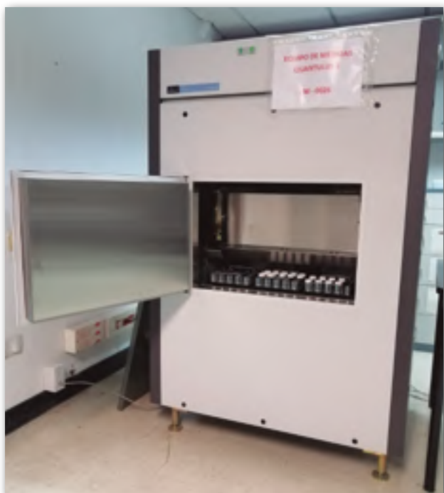
Figura 6. Espectrómetro de centelleo Quantulus 1220 de PerkinElmer utilizado para realizar la medida de los viales con las láminas de ZnS(Ag) en su interior una vez expuestos en un ambiente con ^{222}\text{Rn} .
