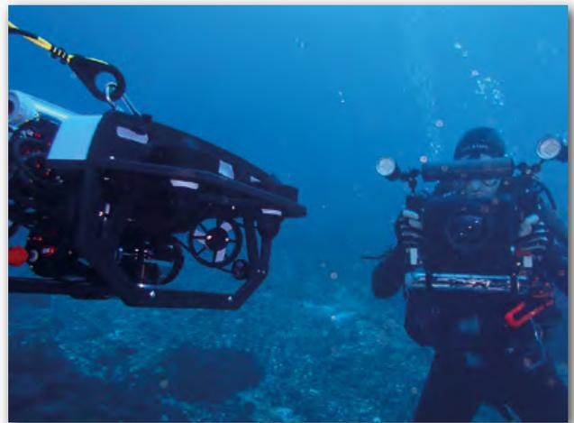
**Figura 2.** Imagen del módulo de fotogrametría desarrollado en el Proyecto VirtualMAR operado por un buceador junto a un ROV ligero.
