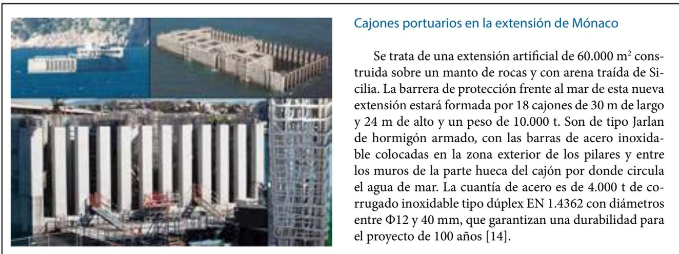
Figura 4. Arriba, desplazamiento de los cajones; abajo, fabricación de los cajones y detalle de armadura © CEDINOX [14].
