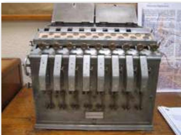
**Figura 7.** Máquina algébrica para resolver ecuaciones de grado ocho.
