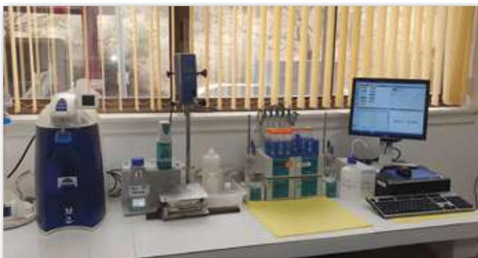
**Figura 6.** Dispositivo para determinación de pH y conductividad eléctrica.
