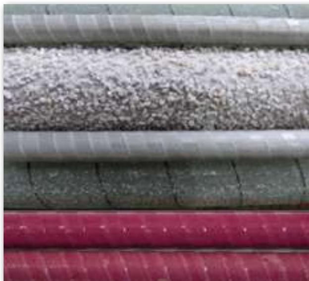
**Figura 6.** Distintas superficies de acabado en armaduras GFRP.
