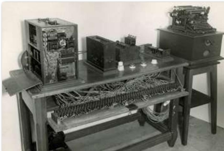
**Figura 14.** El *aritmómetro electromecánico* de 1920.
