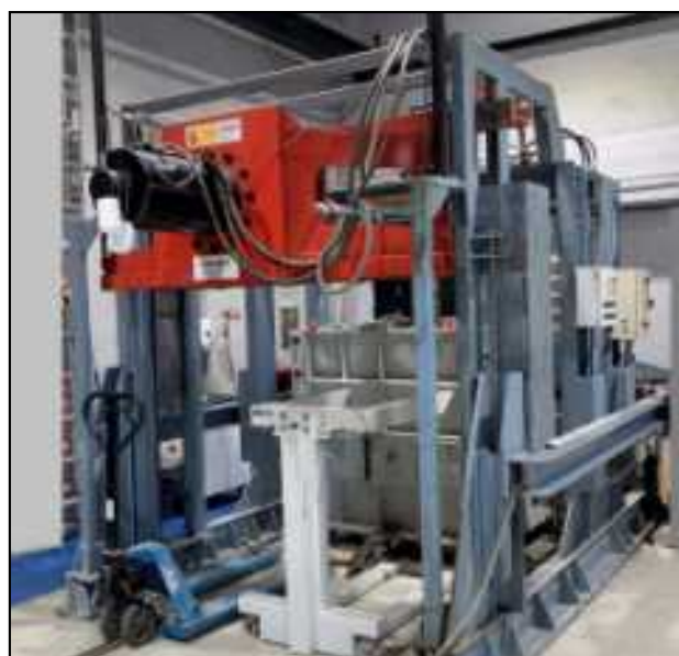
Figura 7. Equipo de corte directo con caja de 1 x 1 m, donde se efectuaron los ensayos.
