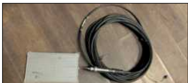
Figura 5. Célula de presión que interviene en los ensayos.
