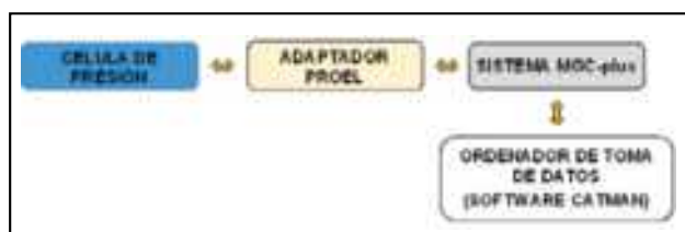
Figura 6. Cadena de medida de la célula de presión en los ensayos.
