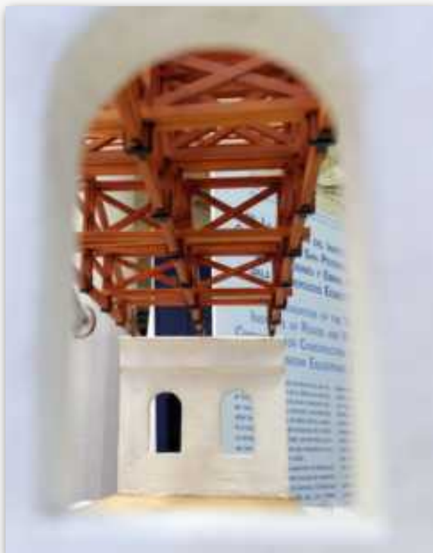
Maqueta de la Sala de Ejercicios Ecuestres de Moscú (Colección de Maquetas de Historia de las Obras Públicas de CEHOPU-CEDEX). Se muestra un detalle de las grandes cerchas de la cubierta diseñada por Betancourt (© 2024 Rufino Pardo).
