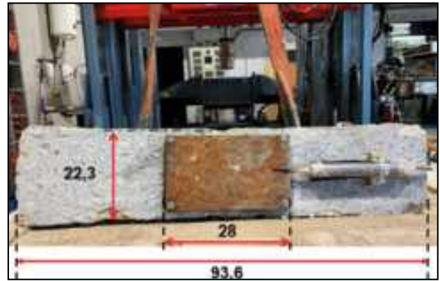
Figura 9. Detalle de la base de la traviesa con la célula de presión instalada.
