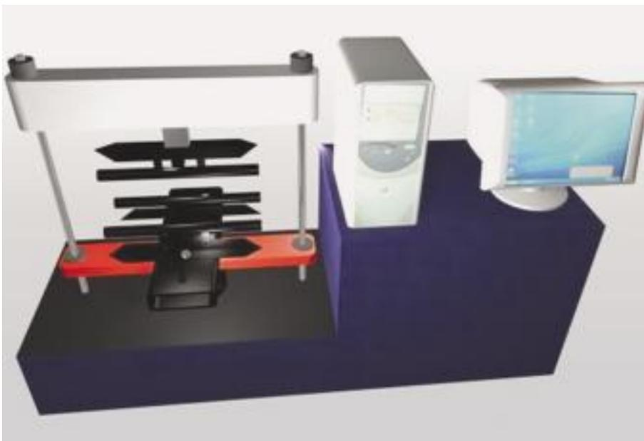
FIGURA 1. Detalle de equipo para rotura a flexión de probetas de mármol.
