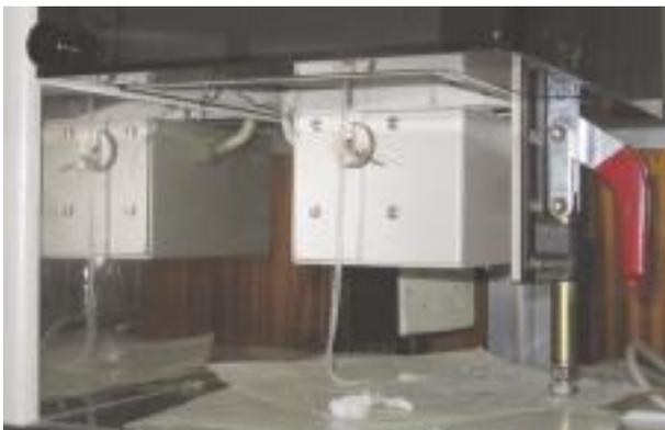
FIGURA 5. Equipo para la determinación del Índice de Fluidez.
