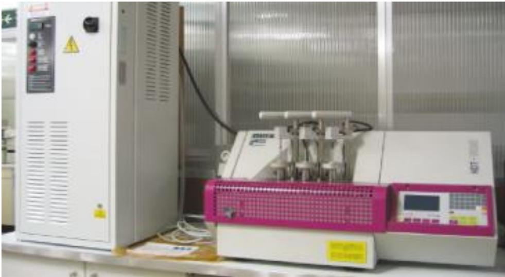
FIGURA 4. Equipo empleado para la determinación de la temperatura Vicat.
