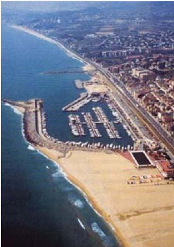
FIGURA 4. Playa apoyada sobre un obra artificial que interrumpe, de manera parcial, el transporte sólido litoral.
