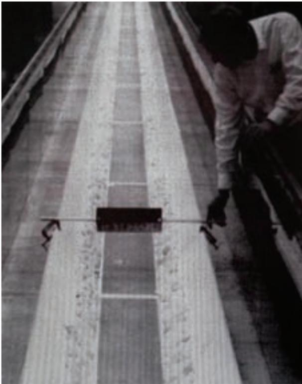
FIGURA 15. Método de inyección del trazador en el flujo.
