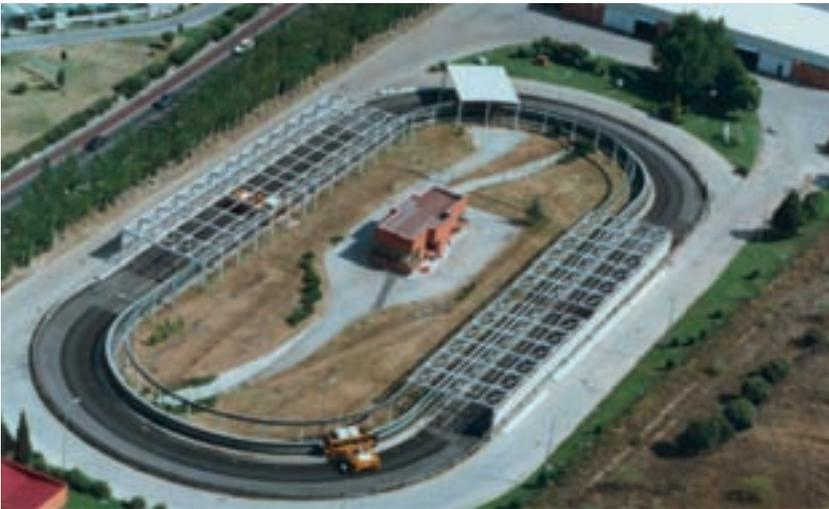
FOTOGRAFÍA 4. Vista de los tramos rectos y circulares de la pista de ensayos.
