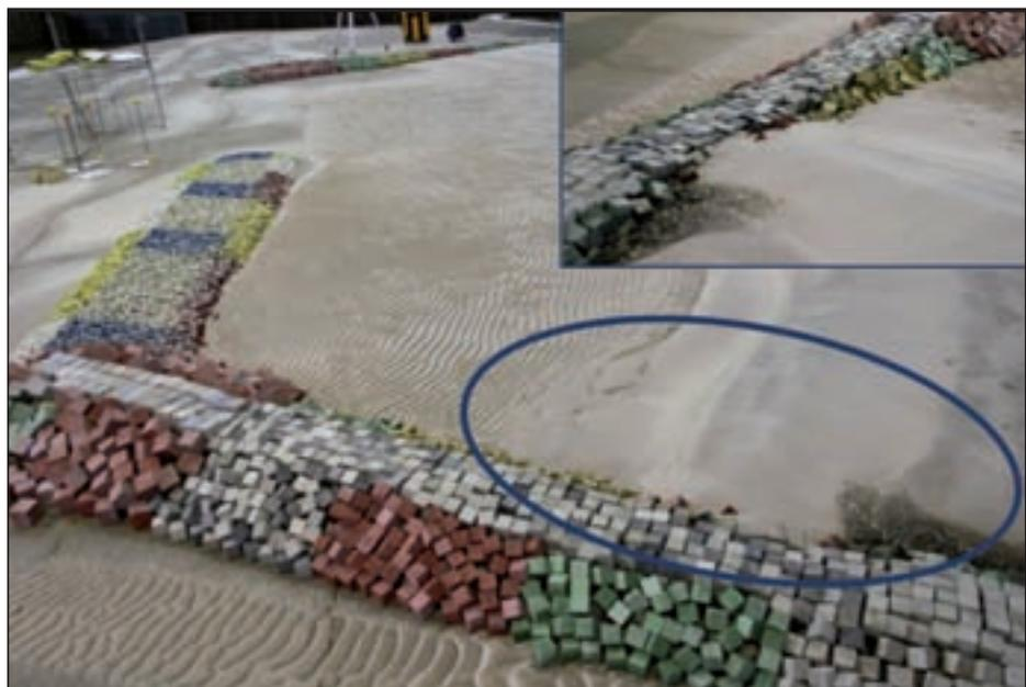
FIGURA 4.5. Ensayo 3. Detalle de la acumulación de material en el dique sur. Estado final.
