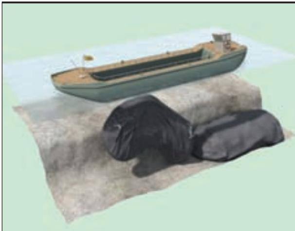
FIGURA 9. Ilustración de un contenedor de geosintéticos vertido. /
