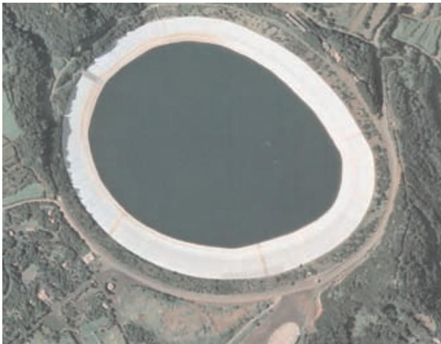
FIGURA 1. Balsa de la Laguna de Barlovento impermeabilizada con una geomembrana de PVC-P.
