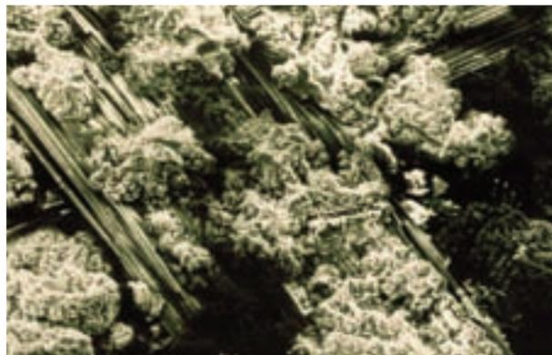
FIGURA 14. Observación por microscopía electrónica de barrido de una lámina de PVC-P donde se aprecia la trama y la urdimbre del textil de refuerzo.
