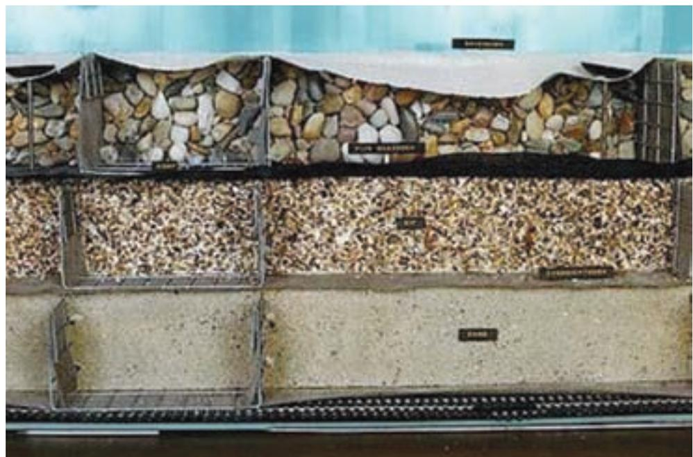
**FIGURA 1.** Colchón del filtro de la barrera contra la marejada ciclónica de la Escalda Oriental. 3 capas granulares. / **FIGURE 1.** Filter mattress Eastern Scheldt storm surge barrier. 3 granular layers.
