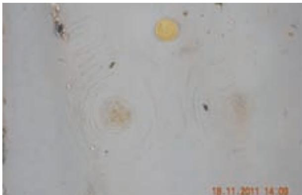
FIGURA 2. Fisuras circulares originadas por punzonamiento en una lámina de PVC llevada al límite de su envejecimiento.
