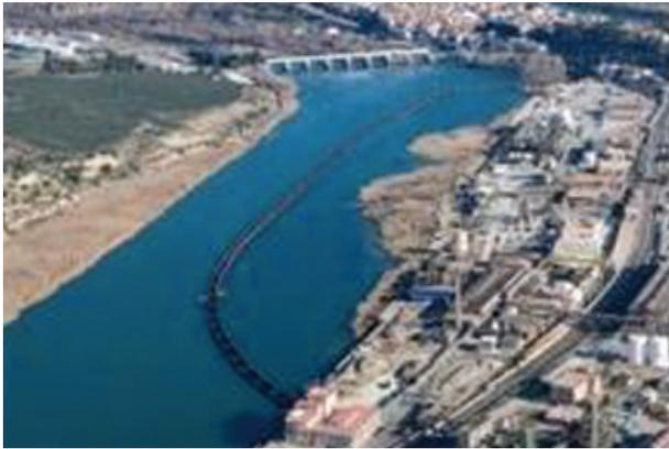
FIGURA 8. Embalse de Flix. Cabe destacar la barrera que impide la propagación de los residuos químicos.
