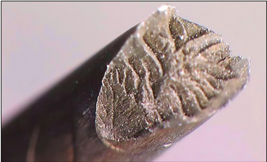
Figura 7. Imagen de rotura de desarrollo típico de corrosión bajo tensión vista transversalmente.
