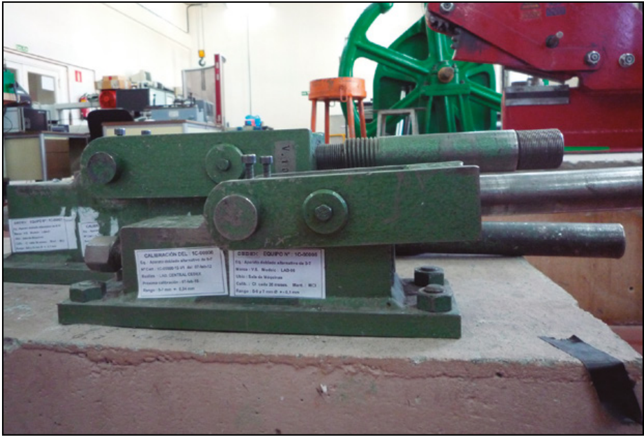
Figura 5. Máquina para el ensayo de doblado alternativo.
