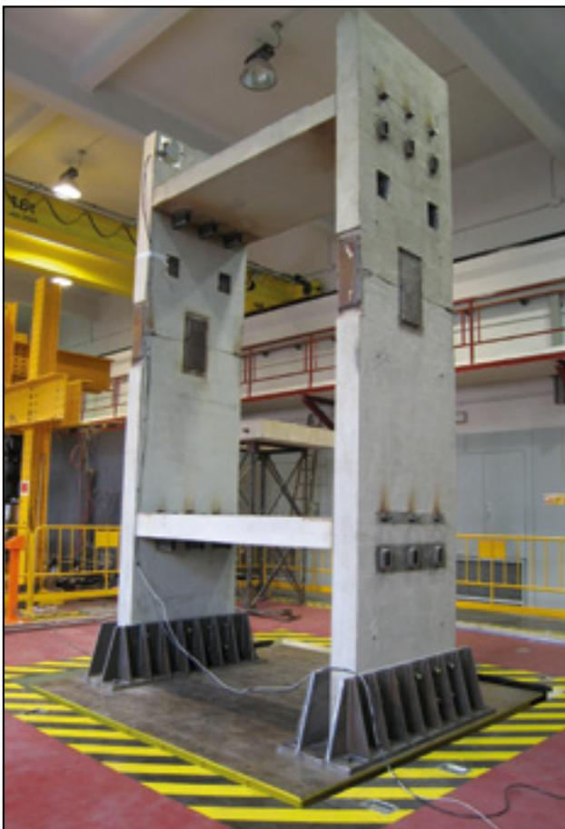
**Figura 2.** Prototipo de ensayo de paneles prefabricados.
