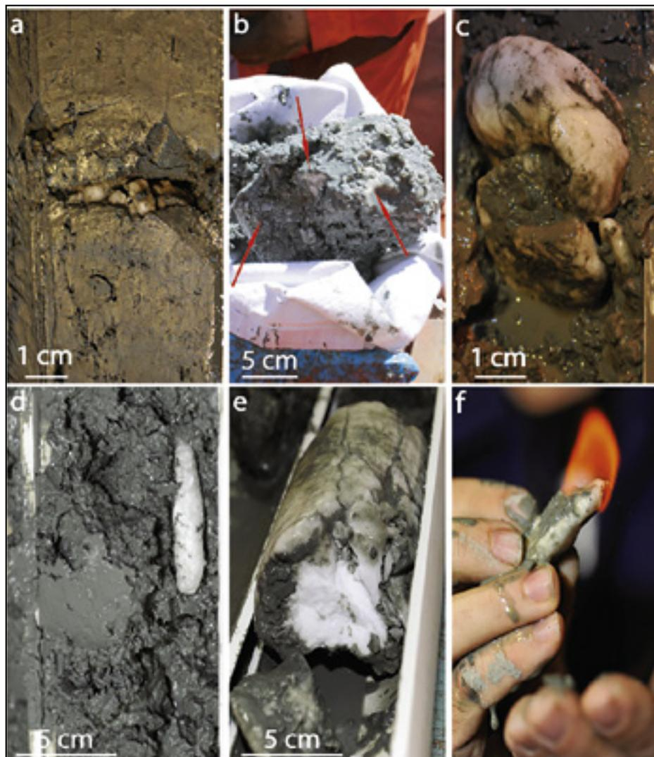
**Figura 5.** Hidratos de gas en muestras de Cono de Río Grande, Brasil, a) capas finas laminadas (2-3 mm de espesor); b) granos de hidratos diseminados en matriz arcillosa; c) nódulos masivos de 2 a 3 cm de diámetro; d) tubos delgados de 1 a 2 cm de diámetro, e) capas masivas (25 cm de espesor) y f) muestra de hidrato de gas encendida. Tomada de Miller *et al.*, 2015.
