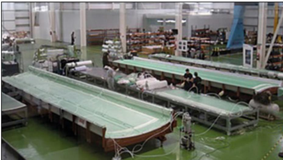
**Figura 10.** Proceso de fabricación de las piezas en la planta de Carbures en Jerez de la Frontera. Procedimiento *Resin Infusion*.
