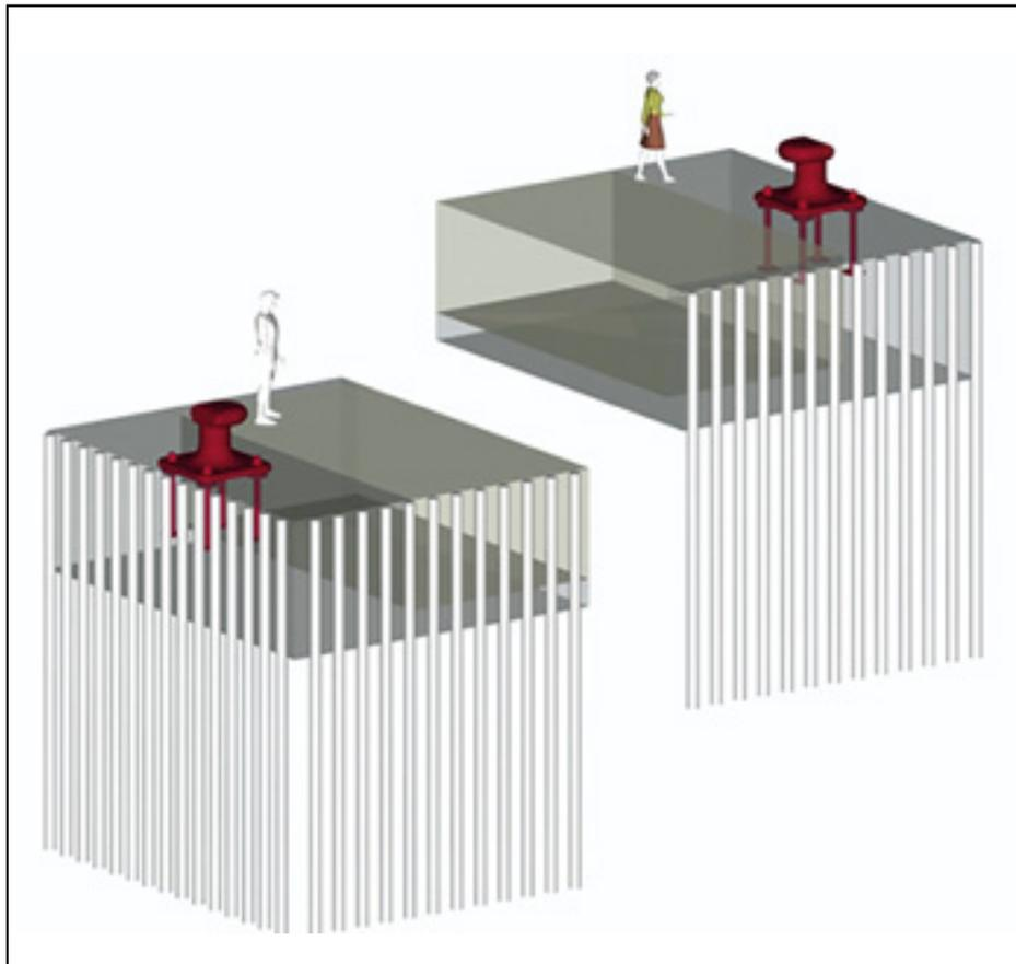
**Figura 8.** Macizo reforzado con micropilotes.
